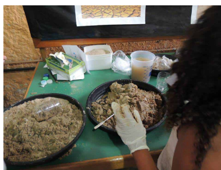
Fig. 2. Atividade 1: montando os filtros de areia e argila.
