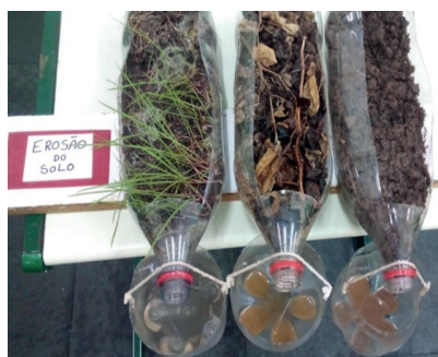
Figura 1: Montagem do experimento do processo de assoreamento.
