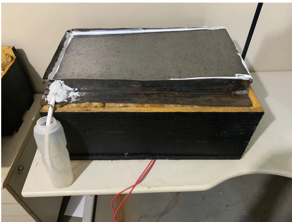
Figura 2 - Protótipo de dessalinização térmico construído de aço inox com revestimento de lã de vidro em um caixote de madeira.
