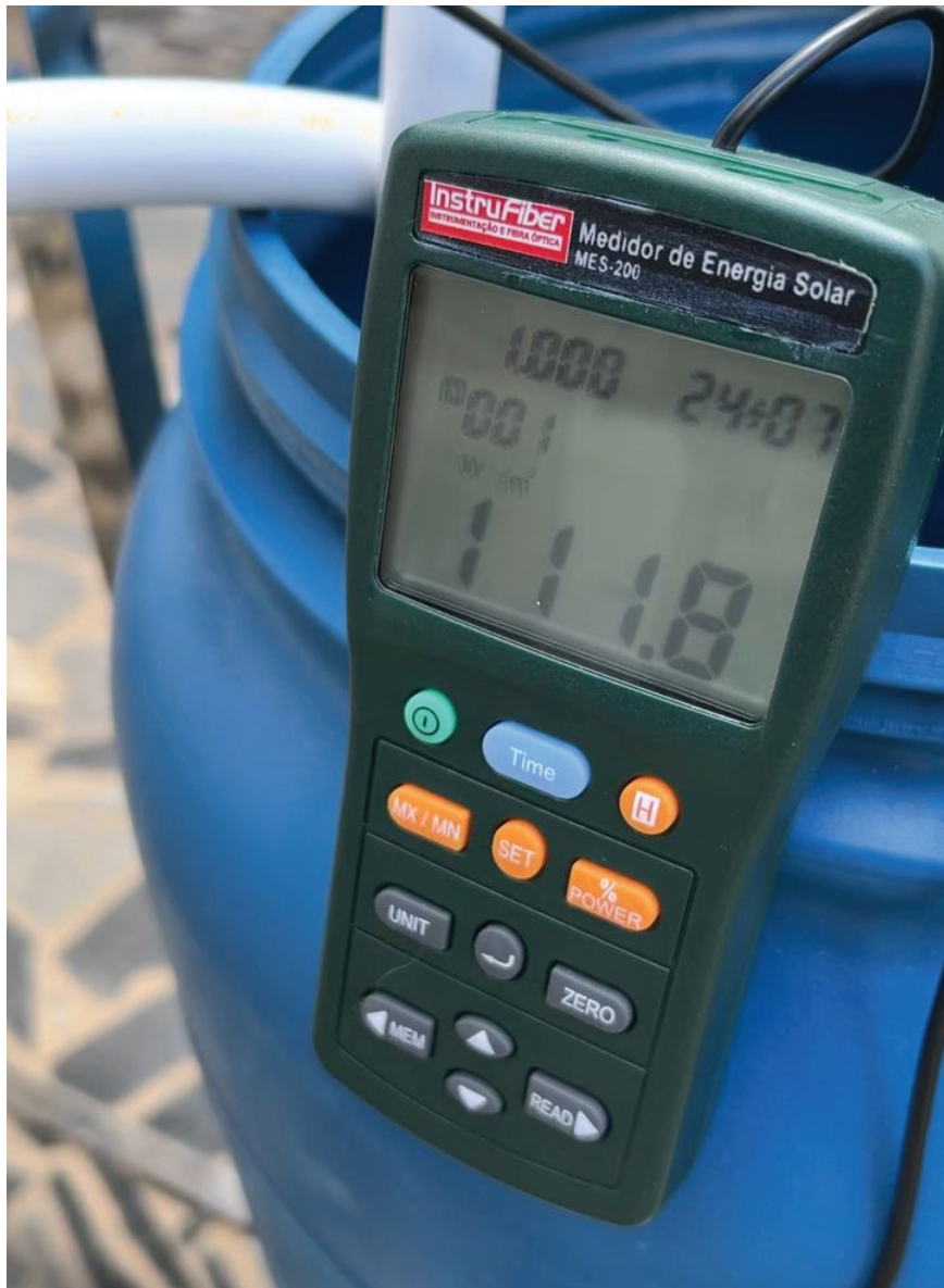
Figura 5 - Piranômetro modelo Mes-200 para medir a radiação solar global.
