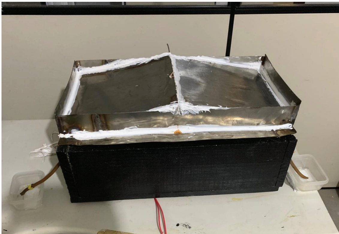
Figura 1 - Protótipo de dessalinização térmico construído de aço inox com revestimento de lã de vidro em um caixote de madeira.
