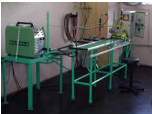
Fig 6. – Equipamento de solda utilizado nos experimentos. Merkle de modelo PU250K.
