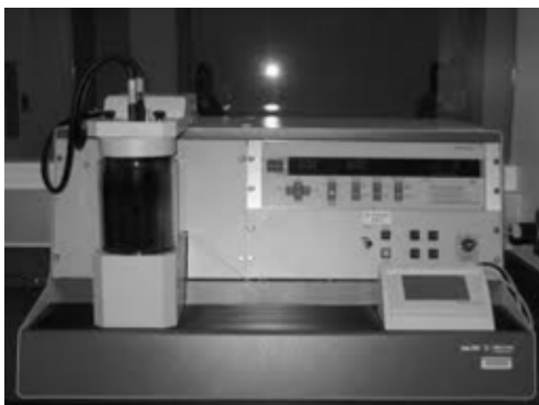
Figura 4. Revestimento da camada de Ouro na superfície dos corpos de prova - Baltec MED 020 – EEL-USP
