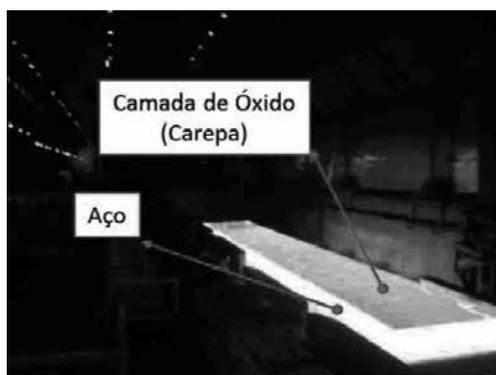
Figura 1. Placa de aço na saída do forno de reaquecimento a 1200 °C.
