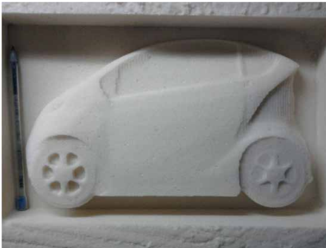
Figura 4: Teste de prototipagem em escala reduzida. Aproximadamente 30cm.
